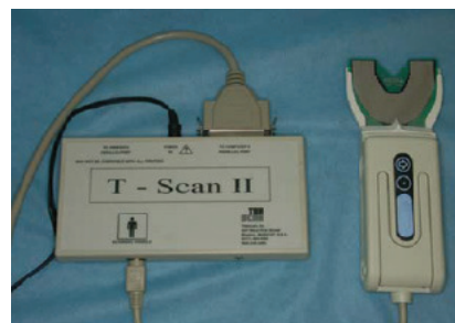
Slika 2. Centralna jedinica (lijevo) i ručni nastavak sa senzorom (desno) T-Scan II sustava
