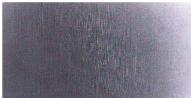
Slika 12b. Frikcijska površina nakon testiranja
