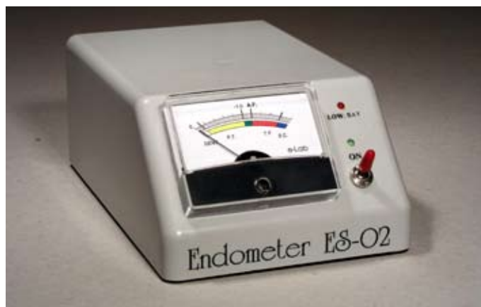
Slika 7. Endometar ES-02 spada u grupu uređaja koji položaj apeksa određuje na temelju određivanja otporne i kapacitivne komponente impedancije.
