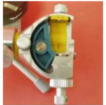
Slika 8. Nastavci za prilagodbu putanje kondilne staze i Bennettove kretnje integrirani u globni nastavak artikulatora
