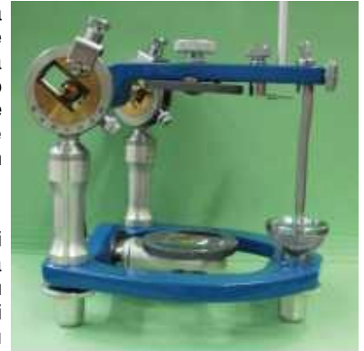
Slika 2. Non - arcon artikulator (Dentatus)
