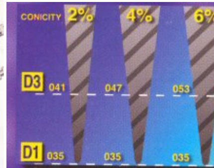
Slika 3. Usporedba koniciteta konvencionalnih i ProFile instrumenata
