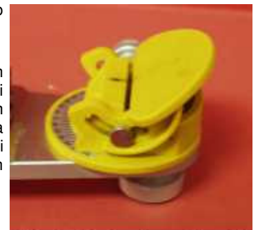
Slika 9. Nastavak za prilagodbu protruzijske kretnje
